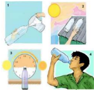
Contoh Teknik Solar Disinfectant /SODIS
